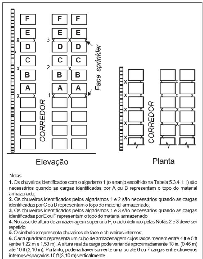
**Figura 5.3.4.4.1(i):** Distribuição de chuveiros internos, mercadorias Classe I, Classe II, Classe III ou Classe IV, altura de armazenagem acima de 7,6 m (25 ft) - **Opção 2.**
