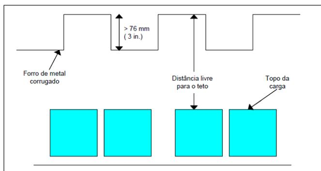
Figura E.3: Forro de metal corrugado com profundidade  $> 76$  mm.
