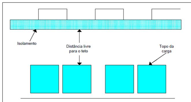
Figura E.4: Forro com isolamento fixado diretamente no teto
