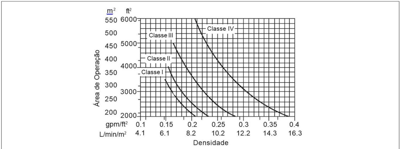
**Figura 5.2.2.1.5.1:** Curvas de projetos de sistemas de chuueiros, armazenagem a 6,1 m (20 ft) de altura - chuueiros de temperatura normal.
