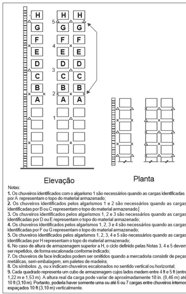
**Figura 5.3.4.4.1(d):** Distribuição de chuveiros internos, mercadorias Classe I, Classe II ou Classe III, altura de armazenagem acima de 7,6 m (25 ft) - Opção 1.
