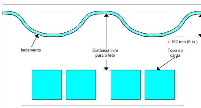
Figura E.6: Forro com isolamento que desvia ou envergua para baixo da estrutura do teto no teto (caso 2)
