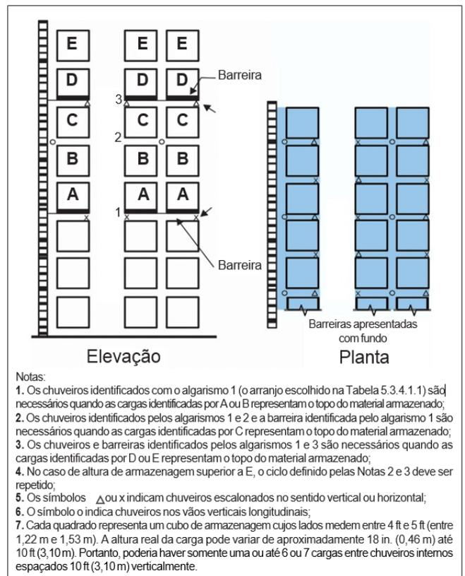
**Figura 5.3.4.4.1(j):** Distribuição de chuveiros internos, mercadorias Classe I, Classe II, Classe III ou Classe IV, altura de armazenagem acima de 7,6 m (25 ft) - **Opção 3.**
