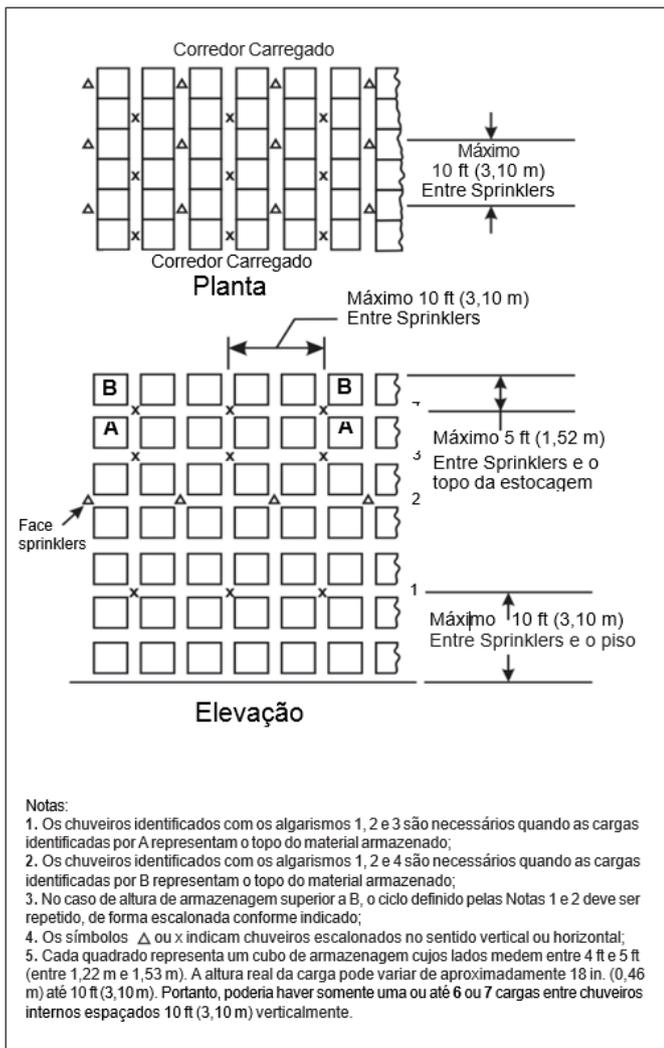
**Figura 5.3.4.4.1.3(c):** Distribuição de chuveiros internos - Estruturas porta-paletes múltiplas, mercadorias Classe I, Classe II, Classe III ou Classe IV, altura de armazenagem acima de 7,6 m (25 ft)
