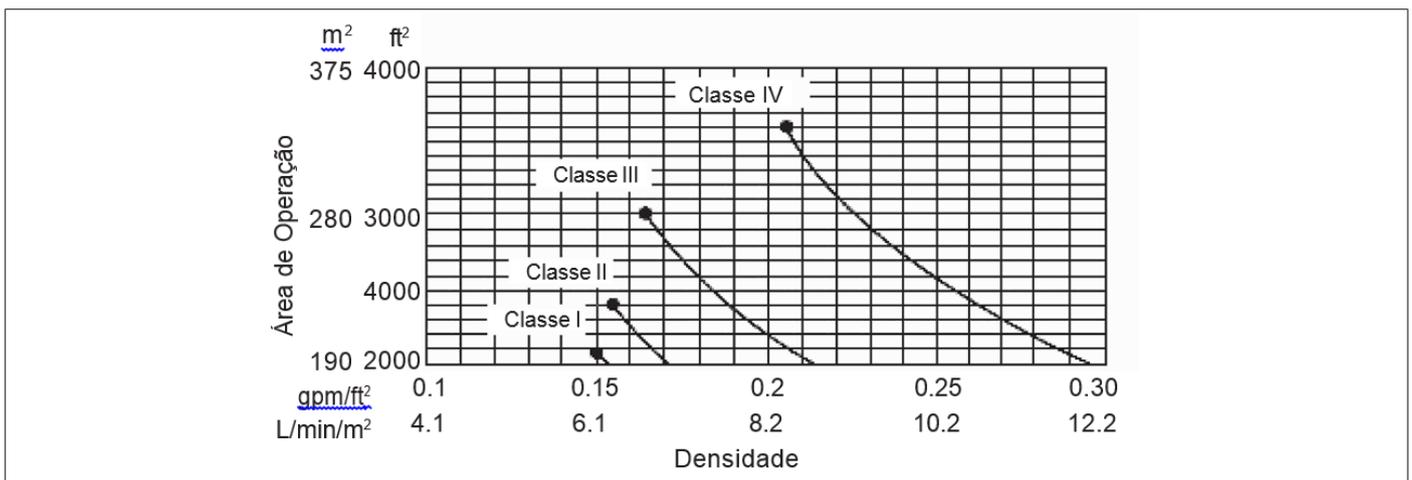
**Figura 5.2.2.1.5.2:** Curvas de projetos de sistemas de chuueiros, armazenagem a 6,1 m (20 ft) de altura - chuueiros de temperatura alta.
