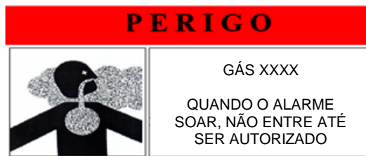
Figura 2 – Sinalização de advertência externas aos ambientes protegidos
