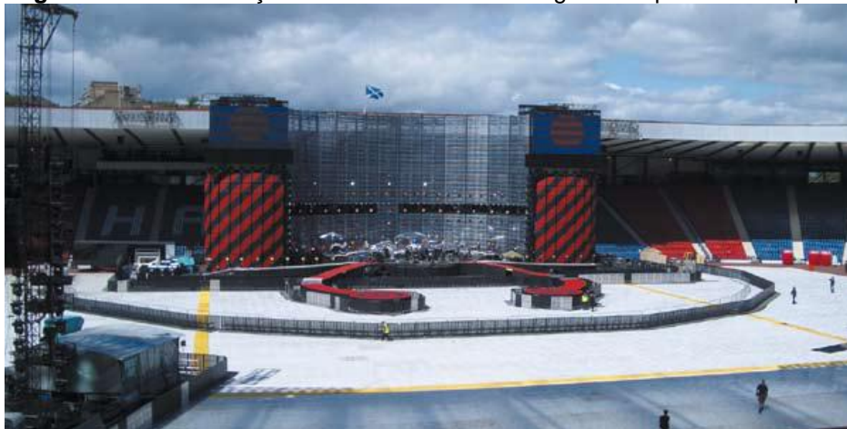
Figura nº 05: Setorização com barreiras antiesmagamento próximas ao palco
