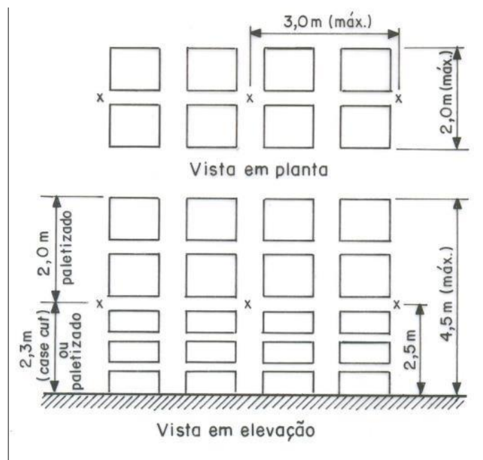
Figura 4.15 - Leiaute de chuveiros automáticos para estrutura-suporte de fileira dupla - Esquema de projeto "G"
