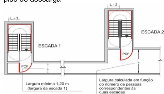
Figura 12: Dimensionamento de saídas no piso de descarga
