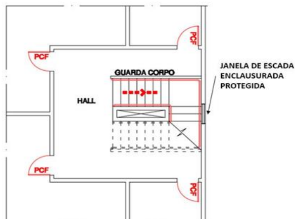
Figura 5: Enclausuramento do hall por Porta Corta Fogo nas unidades autônomas devido à impossibilidade de adaptação de porta na caixa de escada
