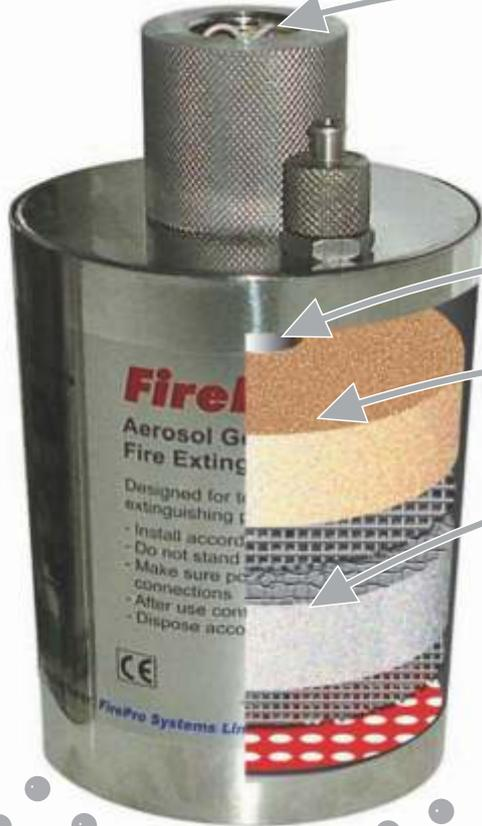
**Ignição:** o **FirePro** pode ser ativado por uma corrente elétrica de 6 a 36 V D/C - 0,8 A, ou pelo *Thermo-Cord* (cordão térmico) a 172°C. A ativação elétrica permite que o disparo do sistema seja comandado por um painel de incêndio. O **FirePro** ainda possui uma terceira alternativa de disparo, que é a auto-ignição quando sua temperatura atinge 300°C. Tais características fazem com que o **FirePro** seja praticamente imune a falhas.
